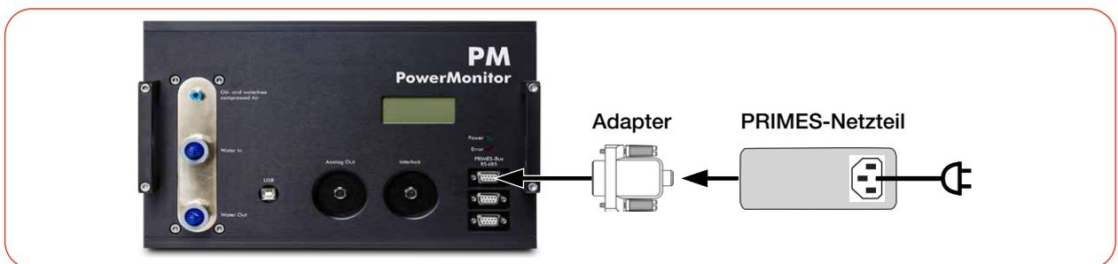
Abb. 8.3: Spannungsversorgung über PRIMES-Netzteil, Anzeige der Messwerte am Gerät (am Beispiel des PM 100)
